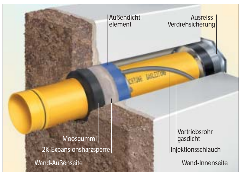
Bild 1: Komponenten der »Zappo«-Vortriebstechnik
